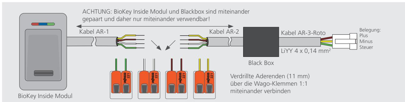
Bei korrekter Verkabelung leuchtet mindestens die blaue LED bei der Außeneinheit konstant. Beim Auslieferungszustand (noch keine Finger eingelernt) leuchten alle LEDs (rot + grün + blau) konstant. Jeder BioKey ist ein unverwechselbares Unikat. Die BioKey Modul Ausseneinheit und die abgesetzte Relaiseinheit (geschützt im Innenbereich, auch Blackbox genannt, vom Werk aus gepaart) 1:1 zu verwenden, wobei die Blackbox im gesicherten Bereich sein muss und nicht von außen zugänglich sein darf!
