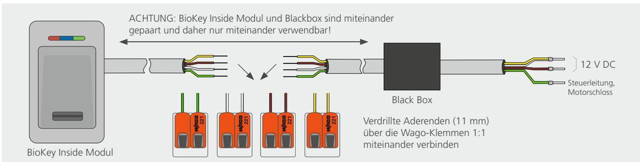
Bei korrekter Verkabelung leuchtet mindestens die blaue LED bei der Außeneinheit konstant. Beim Auslieferungszustand (noch keine Finger eingelernt) leuchten alle LEDs (rot + grün + blau) konstant. Jeder BioKey ist ein unverwechselbares Unikat. Die BioKey Modul Außeneinheit und die abgesetzte Relaiseinheit (geschützt im Innenbereich, auch Blackbox genannt, vom Werk aus gepaart) 1:1 zu verwenden, wobei die Blackbox im gesicherten Bereich sein muss und nicht von außen zugänglich sein darf!
